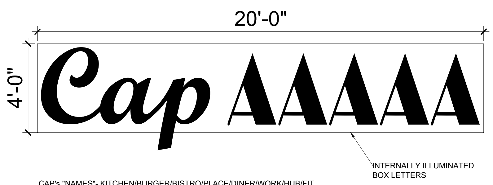
C TYPICAL RETAIL/RESTAURANT SIGN DETAIL (20'x4.92'= 98.4 S.F.) Scale: N.T.S.
